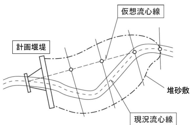
図 9-2-18 縦断の法線形
