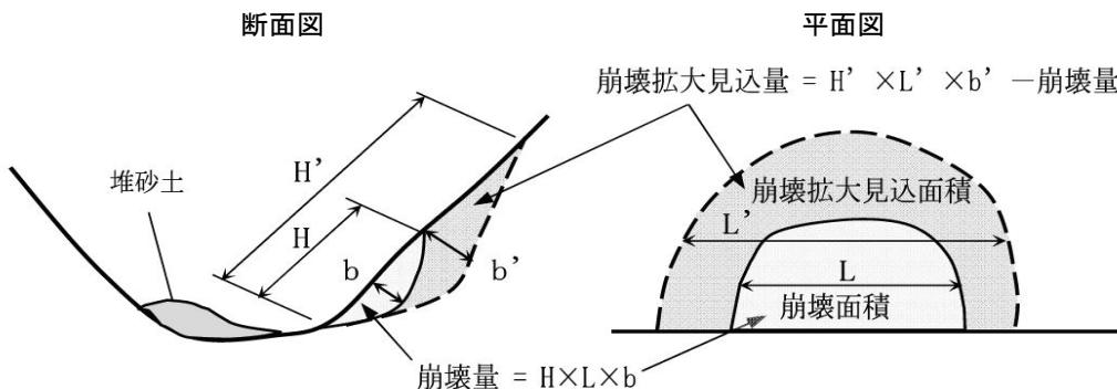
図 9-2-5 荒廃地からの生産土砂量の算出例
