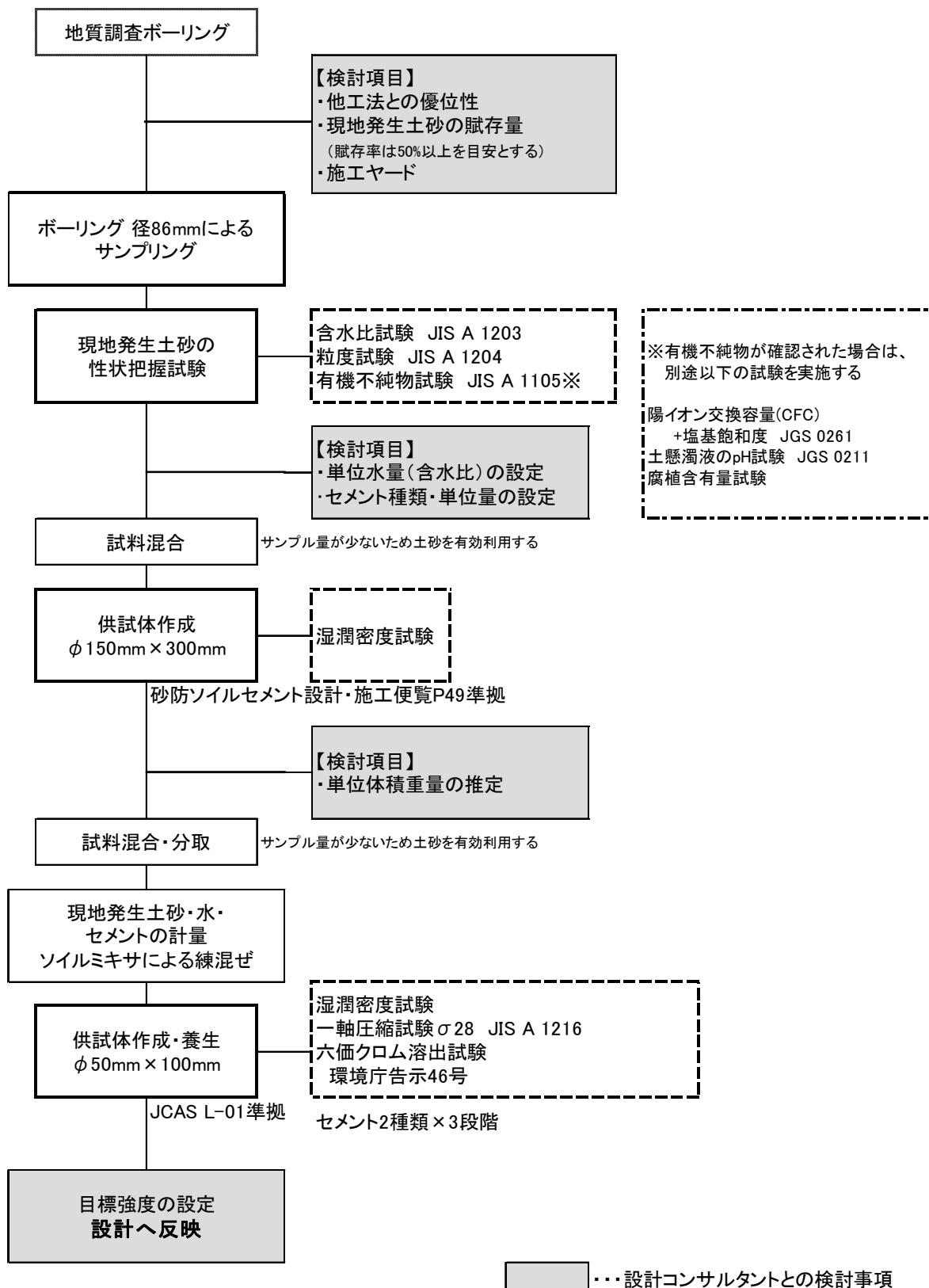
図9-2-15 砂防ソイルセメント工法に関する調査フロー
