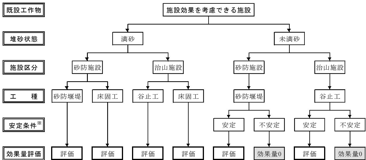
図9-2-4 横断構造物の施設効果量の評価
