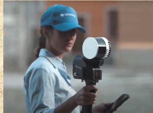
レーザー光を使って対象物の距離や形状を高精度に計測し、3次元点群データを取得する技術。LiDAR-SLAM(計測距離120m)では、移動しながら計測し、対象物をいろいろな方向から計測することが可能です。
