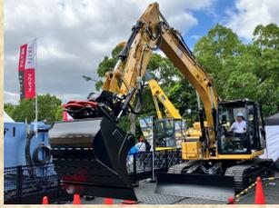
アーム先端部に、左右に傾くチルト機構と360度回転するローテータ機構があり、建機本体を正対させずに自由な方向の掘削が可能。段取り替えが少なくなり作業効率が向上します。
