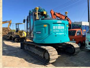
3D-MC機能が付いたチルトローテータショベル。中小規模現場に対応できる13トンクラスの油圧ショベルで、チルトローテータシステムは、スウェーデンのエンコン社製のものが装備されています。
