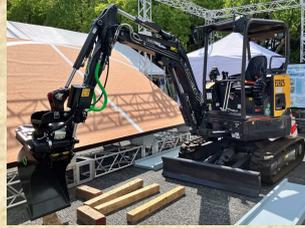
環境に配慮した新型電動GXミニ建機。排気ガスを出さず、エンジン音もしないため、都市部の現場で威力を発揮します。立坑内部での施工や、歩行者との距離が近い場所でも安心な施工を実現します。
